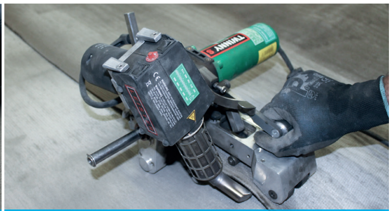
Thermosoudage à l'aide d'outils automatiques
